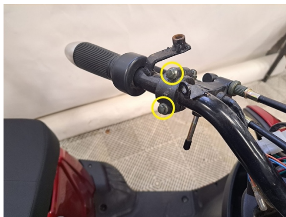
Irrota takajarru vivun kiinnityspultit. (hylsy 8 mm).
